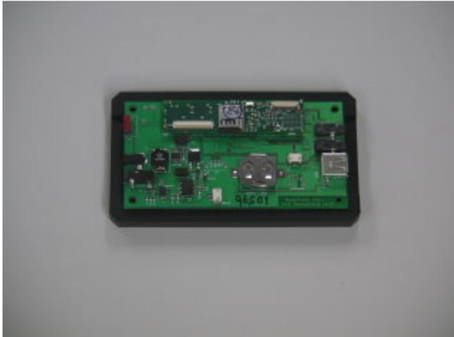
baseboard の反対側に写真のように LCD を入れ、フレキシブルケーブルをコネクタに接続します。
