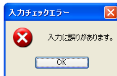
図 5 入力値検証エラー時に表示されるエラーダイアログのデフォルトメッセージ
